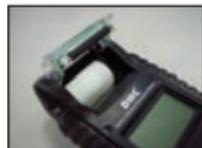
c. Ziehen Sie ein kurzes Stück der Papierrolle aus dem Fach und drücken Sie die Abdeckung zum Schließen hinunter.
